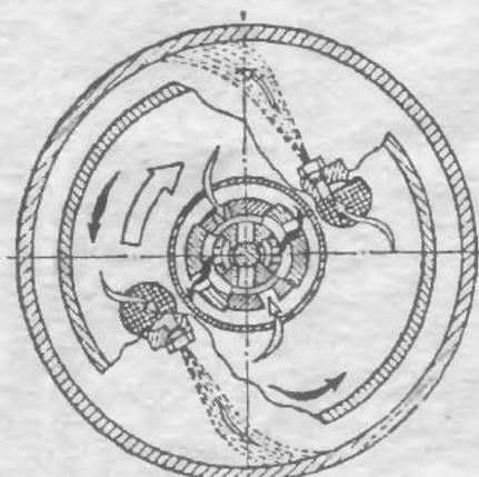
Рис. 22. Схема реактивной центрифуги: 1 - корпус; 2 - колпак; 3 - стакан корпуса ротора; 4 - ось корпуса ротора; 5 - стакан, отделяющий полости очищенного масла от неочищенного; 6 - отверстия отвода очищенного масла; 7 - предохранительная сетка; 8 - отверстия подвода неочищенного масла; 9 - жиклер (сопло); 10 - трубка отвода очищенного масла; 11 - канал подвода масла от насоса
