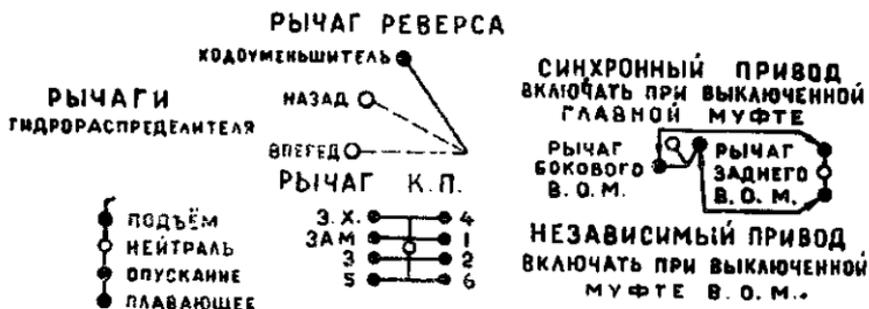
Рис. 4. Схема положений рычагов управления.
