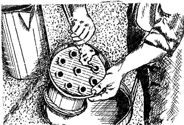
Рис. 19. Промывка циклонов воздухоочистителя.
