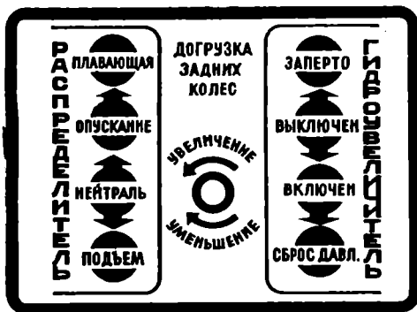
Рис. 9. Схема управления распределителем и ГСВ (тракторы с серийной кабиной).
