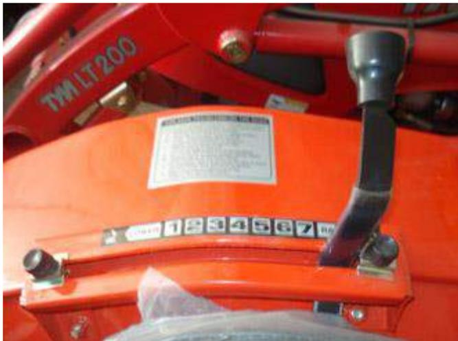
Управление положением предназначено для определения и сохранения желаемого положения навесного оборудования с помощью рычага.
