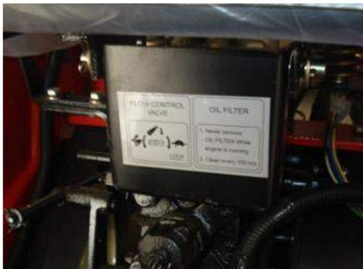
MT180D оснащен ручкой управления потоком, которая контролирует скорость опускания навесного оборудования. Она расположена перед картером гидравлики под креслом.
