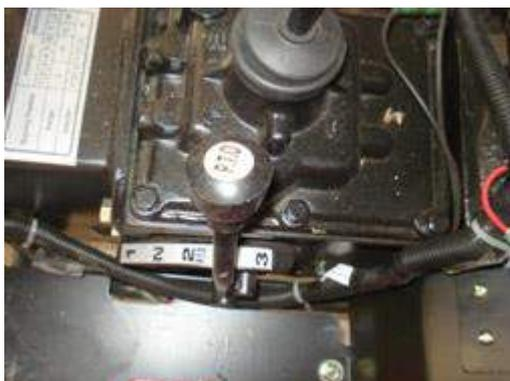
Управляя рычагом переключения передач РТО, расположенным слева от картера трансмиссии, можно выбрать три скорости вращения вала РТО. При перемещении рычага переключения передач РТО, снизьте скорость работы двигателя, нажмите педаль сцепления до упора, чтобы отключить передачу мощности от двигателя, и проверьте чтобы машина достигла полной остановки.
