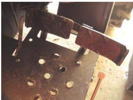
Тормоз внутреннего расширительного типа защищен от попадания грязи и воды. Справа от картера трансмиссии расположены две сцепленные вместе педали. Тормоз включается нажатием на эти педали. Чтобы остановить трактор сбросьте скорость работы двигателя, нажмите педаль сцепления, а затем нажмите педаль тормоза.
