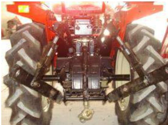
Этот трактор оснащен трехузловой сцепкой категории 1, которая поставляется в качестве дополнительного оборудования. Устанавливаемое навесное оборудование должно соответствовать трехузловой сцепке.
