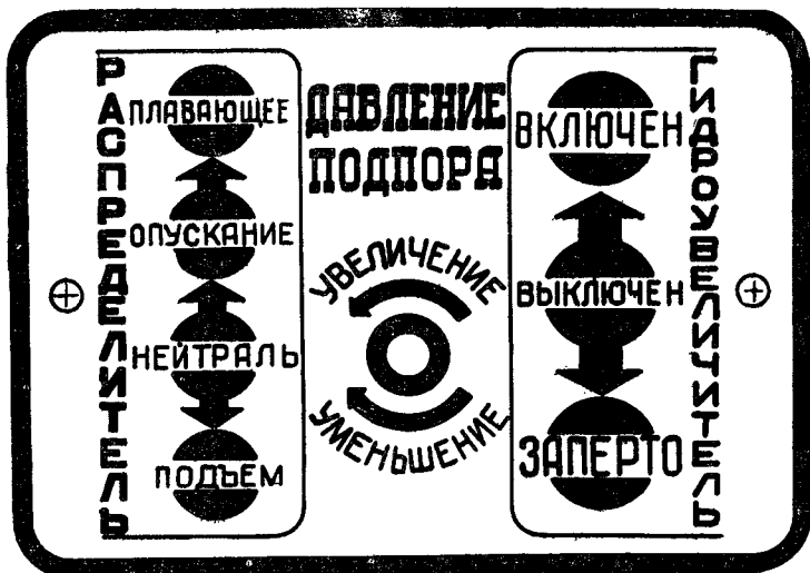
Фиг. 8. Схема управления гидросистемой трактора.
