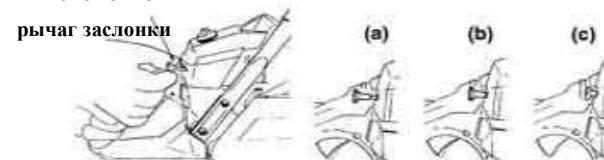
Примечание: после запуска двигателя установите головку воздушной заслонки в положение первой фазы (воздушная заслонка открыта, а сектор газа в начальном положении).
