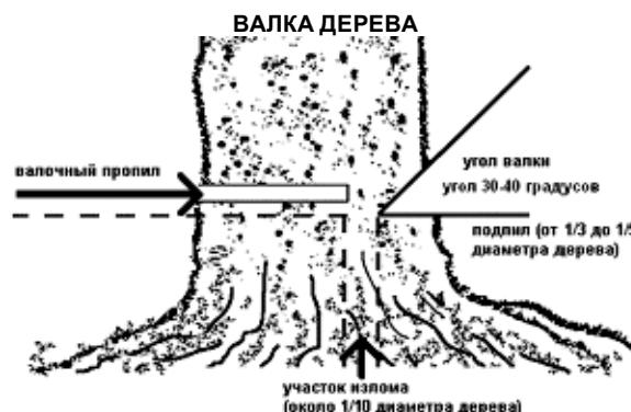
1. Определите направление валки с учетом ветра, наклона дерева, расположения тяжелых ветвей, легкости выполнения задачи после валки и других факторов.
